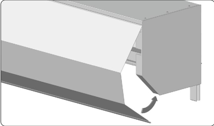
21. Setzen Sie die Revisionsklappe des Kastens auf.
