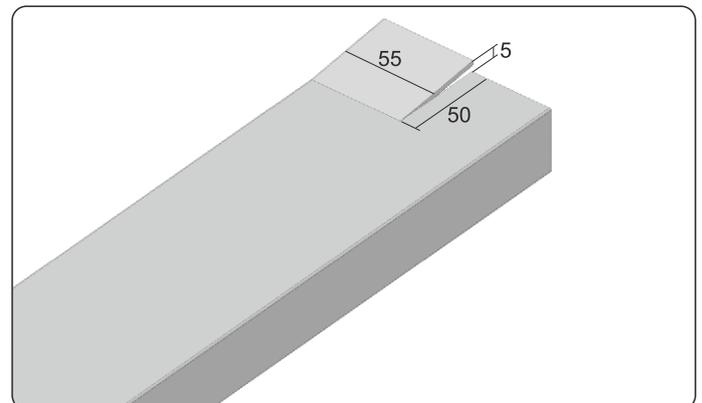
4. Biegen Sie die ca. 5 mm eingeschnittene Wand ab, um den Panzer verlegen zu können.
