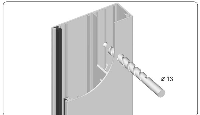
2. Erweitern Sie mit einem Bohrer mit einem Durchmesser von 13 mm das Loch nur in der ersten Kammer an der Außenseite der Führungsschiene.
