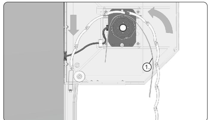
16. Nach Überprüfung der Motorfunktion verlegen Sie den Panzer durch das Wickelrohr mit der Unterleiste nach unten. **Vor dem Einschleiben des Panzers sichern Sie das Wickelrohr ab, sodass das Profil (1) nicht beschädigt wird.**
