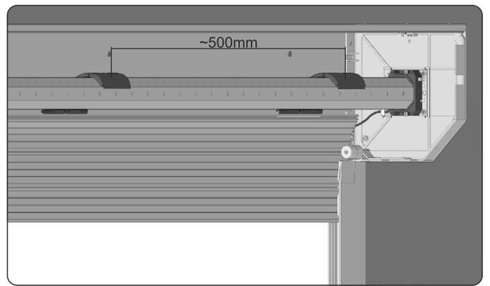
20. Die Gehäuse sind in einem Abstand von 500 mm zu montieren.
