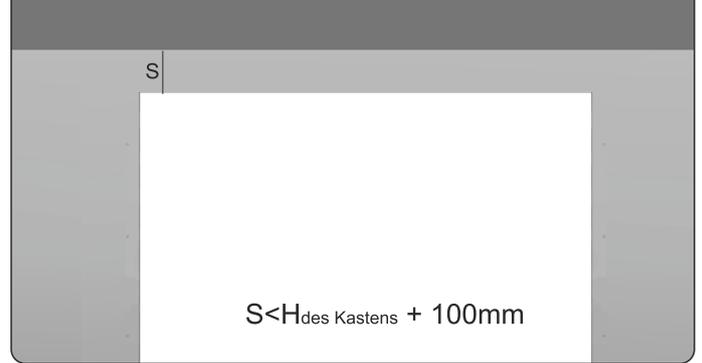
9a. Wenn die Höhe S geringer ist als H des Kastens + 100 mm, ist der Rolltorkasten auf die Führungsschienen (als Satz) aufgesetzt zu montieren.
