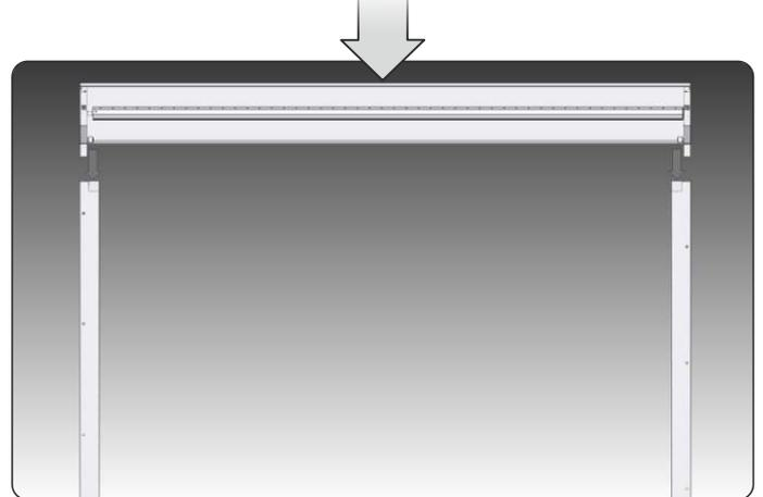
10a. Schieben Sie den Kasten auf die Führungsschienen.
