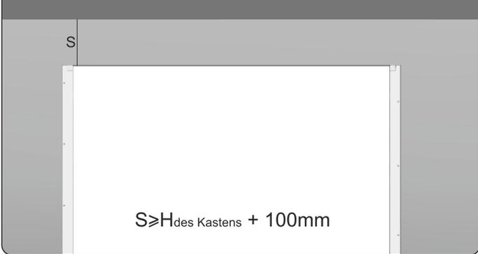
9. Die Mindesthöhe S für die Montage des Rolltorkastens wird bei den festgeschraubten Führungsschienen gemessen, indem man die Kastenhöhe um 100 mm vergrößert.
