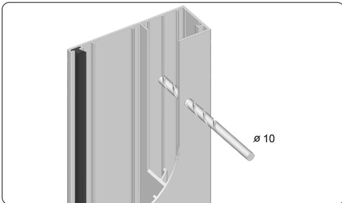
1. Bohren Sie Löcher in den Führungsschienen an. Bohren Sie unter Einsatz eines Bohrers mit einem Durchmesser von 10 mm ein Loch durch die beiden Kammern der Führungsschiene.
