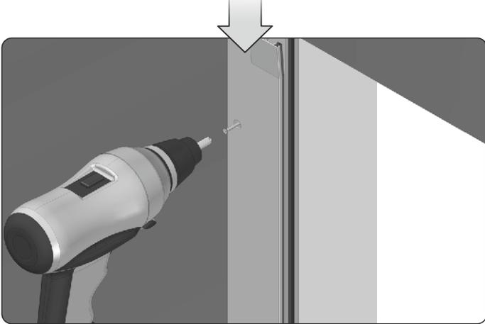
10. Schrauben die Führungsschienen an die Wand fest.
